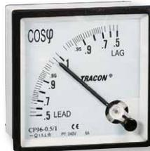
Questi dispositivi misurano il fattore di potenza dei sistemi di uno o di tre fasi nel campo 0,5 capacitivo - 0,5 induttivo. Se la corrente è superiore a 5 A deve essere utilizzato un trasformatore di corrente secondaria di 5 A. A seconda del carico capacitivo o induttivo del sistema, l'indicatore si sposta verso sinistra (capacitivo) o verso destra (induttivo) della scala simmetrica. Il trasduttore viene installato nell'alloggiamento.
