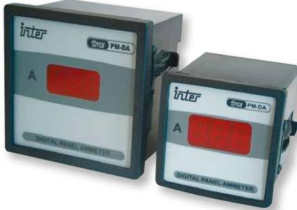
Questo dispositivo è in grado di misurare la corrente fino a 50 A direttamente, senza ulteriori accessori. I morsetti estraibili per l'alimentazione sono sul lato posteriore del dispositivo. Anche l'entrata del misuratore di corrente, che è un trasformatore incorporato con rapporto 50/5A a bassa tensione, si trova sul retro del dispositivo ed il conduttore della fase deve passare attraverso questo trasformatore.
