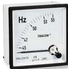
Utilizzati per misurare la frequenza di rete a bassa tensione nella gamma 45 ... 55 Hz. La tensione deve essere collegata ai morsetti del dispositivo; lo strumento visualizza il valore della frequenza tramite l'ausilio di un trasduttore racchiuso all'interno dell'unità.
