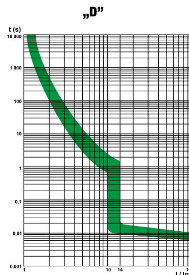
Zum Schutz von Motoren mit starkem Anlaufstrom, Transformatoren, andere induktive Anlagen
