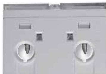
Die Leitung soll durch das Fenster geführt werden. Danach wird der Kontakt durch Eintreiben der Schraube und Durchschneiden der Isolierung hergestellt. Für dünnere Leitungen stellen wir einen Verengungsring bereit.
