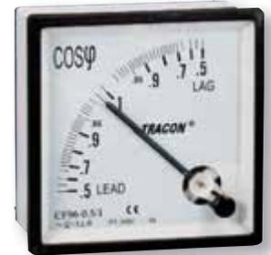
Diese Instrumente messen den Leistungsfaktor im ein- oder dreiphasigen Netz, im Bereich von 0,5 kapazitiv bis 0,5 induktiv. Überschreitet die Stromstärke im Messkreis 5 A, muss ein Stromwandler mit Sekundärstrom 5 A eingesetzt werden. Der Zeiger schlägt links (kapazitiv), bzw. rechts (induktiv) aus, abhängig von der Last.
