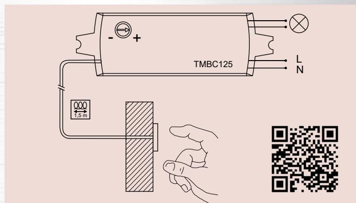
Tip TMBC125 je kapacitivni prekidač, čija senzorska žica mora biti fiksirana na metalnu površinu. Tako dodirujući metalnu površinu, bilo gde se može se uključiti sa svetiljkom povezanim na jedinicu. Ovaj režim za prebacivanje, odličan je za kontrolu aluminijumskih LED traka. One se tako mogu uključiti dodirivanjem bilo koje tačke na šini.
